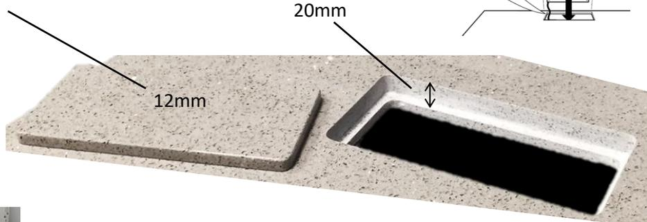
CUTTING OF STONE MATERIALS SUCH AS GRANITE & QUARTZ IS A **FACTORY PROCESS** SO PLEASE INVOLVE THE FABRICATOR OF SUCH MATERIALS IN THE DESIGN & SPECIFICATION PROCESS
