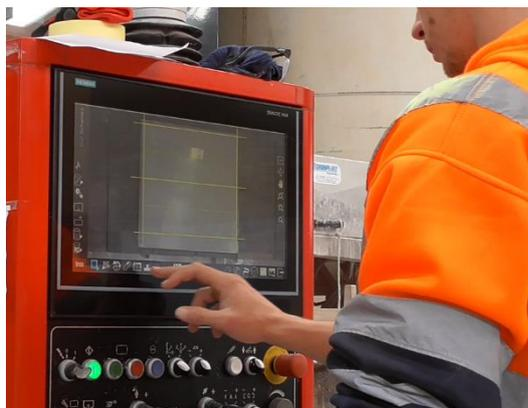
LAS HERRAMIENTAS DE CORTE (*TÍPICAMENTE CORTADORA TRANSVERSAL y TORNILLO CNC*) SE PROGRAMAN CON LAS DIMENSIONES NECESARIAS.
