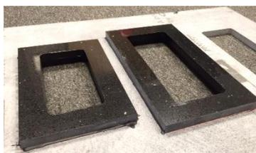
**Falso rebaje utilizando CUARZO de 20mm**
