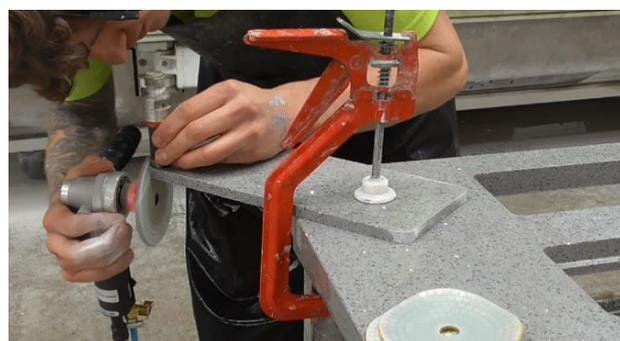
LAS ESQUINAS SUELEN REDONDEARSE A MANO PARA GARANTIZAR QUE LAS ENCIMERAS A MEDIDA ENCAJEN PERFECTAMENTE CON EL RADIO INTERNO DE LOS ORIFICIOS. LA EXPERIENCIA Y HABILIDAD DEL PROVEEDOR DE ENCIMERAS GARANTIZA QUE TODO ENCAJE A LA PERFECCIÓN IN SITU.
