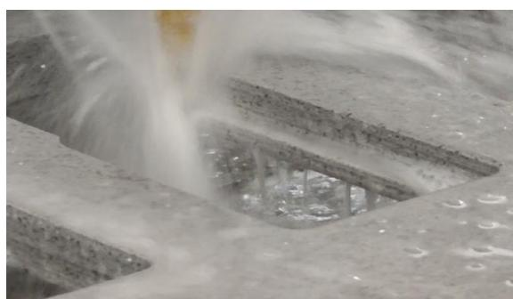
PARA CREAR EL REBAJE EN MATERIAL DE 30mm - EL ROUTER REALIZA DOS PROCESOS: EL PRIMERO ES UN AGUJERO TOTALMENTE RECORTADO. EL SEGUNDO ES UN AGUJERO EXTRA DE 8mm, A 20mm DE PROFUNDIDAD.
